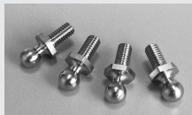
AJ4301N ¥450(税別) メッキジョイントボール座付きφ4.3:4個入 表面に硬質メッキを施し、摺動性と耐久性を向上させたφ4.3mmジョイントボールです。表面硬さHV600位上
